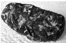
Рисунок 5. Минеральный агрегат на примере сильвина
